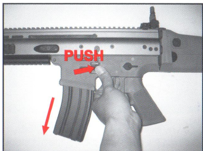
左側使用彈匣卡筭(壓下彈匣卡筭,彈匣即脫落) Push the magazine release button on left side for left hand shooter.
