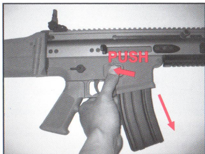
右側使用彈匣卡筭(壓下彈匣卡筭,彈匣即脫落) Push the magazine release button on right side for right hand shooter.
